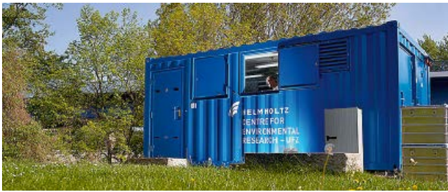
Abb. 2: Mobile Mesokosmenanlage MOBICOS: Das Helmholtz-Zentrum für Umweltforschung – UFZ betreibt an mehreren Standorten in Mitteldeutschland diese container-basierte Forschungsinfrastruktur zur Untersuchung funktioneller Zusammenhänge in Fließgewässern unter naturnahen Bedingungen. Natürliches Flusswasser wird im am Gewässerrand aufgestellten Container durch fragestellungsspezifisch anpassbare Versuchsansätze (z. B. Fließrinnen) gepumpt, was die experimentelle Manipulation von natürlichen und anthropogen geprägten Umweltfaktoren in replizierbaren Versuchsansätzen erlaubt. Eine detaillierte Beschreibung der Mesokosmen-Infrastruktur geben Fink et al. [24]. Weitere Informationen unter https://www.ufz.de/index.php?de=42379 (Foto: André Künzelmann, UFZ).
